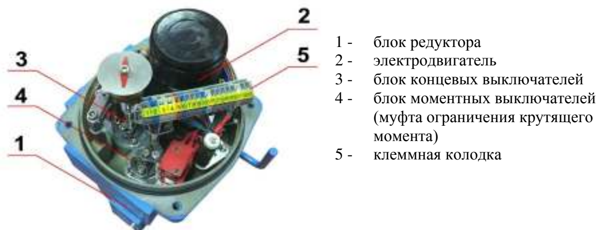
Рис. 2. Основные элементы конструкции электропривода тип QT
